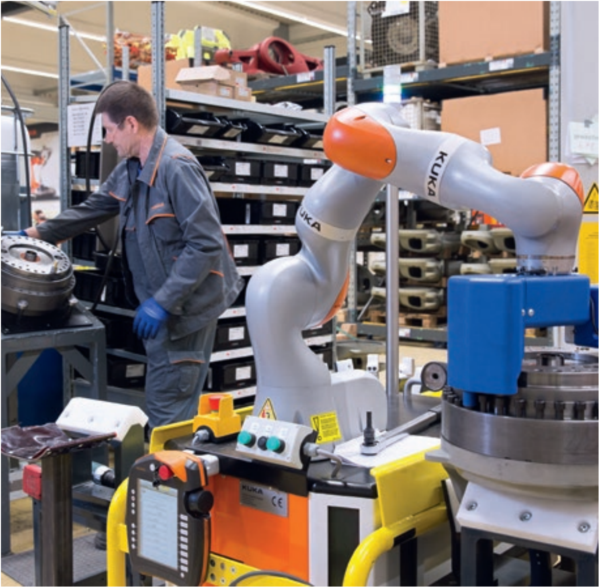
Der „LBR iiwa“, für die Mensch-Maschine-Kollaboration entwickelt, wird auch bei der Produktion von seinesgleichen im Kuka-Werk Augsburg eingesetzt. Der Leichtbaurobter ist PC-gesteuert und basiert auf Microsoft-Technologien
